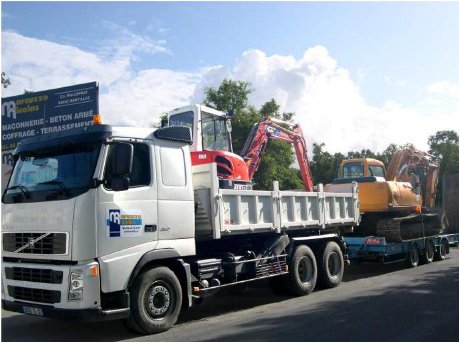
*Camion 6x4 avec benne amovible et Porte-engin 35 Tonnes*
